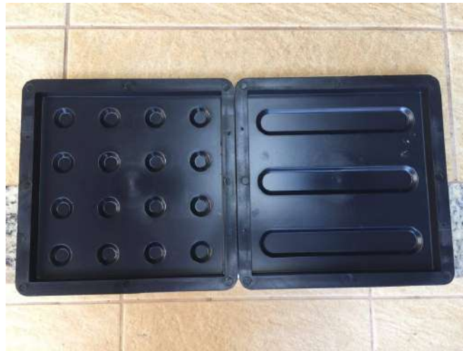
Figura 1 – Molde do ladrilho hidráulico piso tátil do tipo alerta (esquerda) e direcional (direita).
