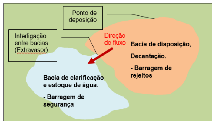
Figura 14 – Barragem para adensamento de rejeitos e barragem de água. Fonte: Próprio Autor (2017).
