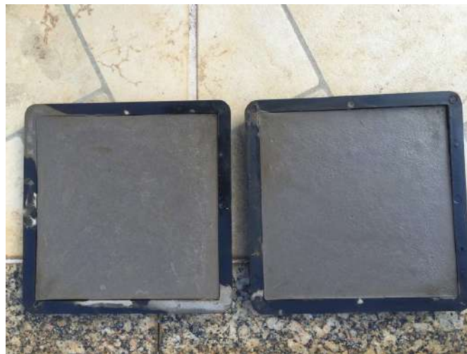
Figura 2 – Molde do ladrilho hidráulico com a mistura.
